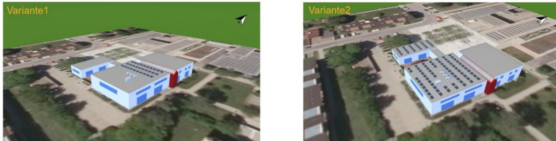
Abbildung 20: Simulation der Photovoltaikanlagen in zwei Szenarien (links 9,9 kWp, rechts 29 kWp)
